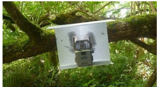
Caméra installée avec son cache de protection (E. Portier)
